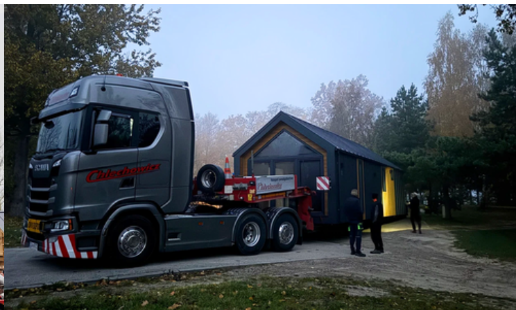
Tir z naczepą EURO niskopodwoziową, na której dom porusza się po drodze
